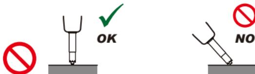
請勿對溫度探針的針尖施加過大的撞擊，或強行彎曲測試線。以防造成故障或斷線。
