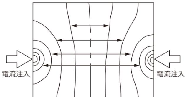
圖1：在金屬板的電流分布（寬  $300 \times$  長  $370 \times$  厚  $0.4$ ）端點注入  $1\text{ A}$  的電流，將每  $50\text{ }\mu\text{V}$  的等電位線繪製成圖形
