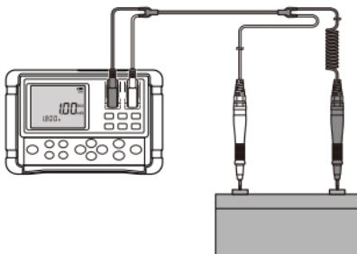
端子溫度測量需要 9460 附溫度感測器夾型測試線 (選配品)。環境溫度測量需要 9451/9451S 溫度探針。
