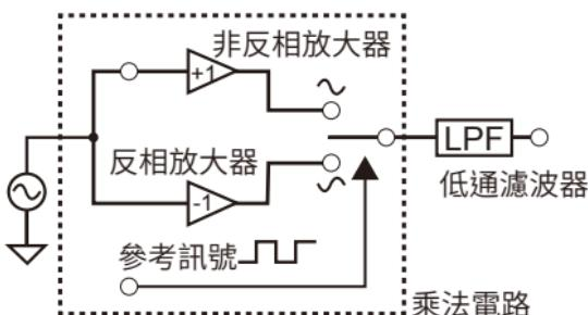
假設本產品產生的交流電流的基準訊號電壓為  $v_1$ ，進行同步檢波的訊號電壓為  $v_2$ ，則可以表示為如下。 $v_2$  的  $\theta$  表示由為電抗部分產生的相對於  $v_1$  的相位差。
