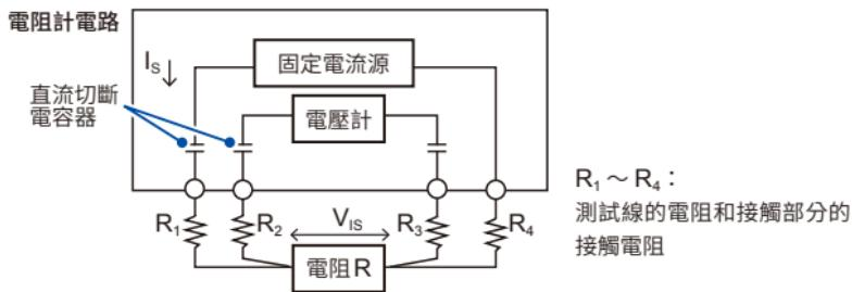
將交流電流  $I_s$  從本產品的 SOURCE 端子，輸入測量對象。利用 SENSE 端子測量因測量對象的阻抗所造成的電壓下降  $V_{IS}$ 。這時，SENSE 端子被連接到內部的高阻抗電壓計上。因此，表示測試線的電阻和接觸電阻的電阻  $R_2$  和  $R_3$  上幾乎沒有電流流過。也幾乎沒有電阻  $R_2$  和  $R_3$  的電壓下降。這樣的話，電阻  $R_2$  和  $R_3$  的電壓下降就被抵銷了。本產品透過同步檢波方法，將測量對象的阻抗分為有效電阻和電抗，而僅顯示有效電阻。
