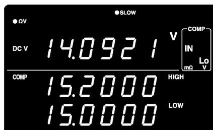
测量显示的切换仅在使用  $\Omega V$  功能，比较器为 ON 的情况下有效。
