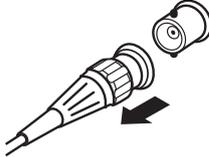
본 기기를 사용할 때는 반드시 당사가 지정한 측정 프로브 및 온도 센서를 사용해 주십시오. 지정한 것 이외의 제품을 사용하면 접촉 불량 등으로 인해 정확하게 측정할 수 없는 경우가 있습니다.
