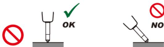
Schützen Sie die Spitze des Temperaturmessfühlers vor Erschütterungen und achten Sie darauf, dass keine Verbiegungen in der Leitung auftreten. Dadurch kann es zu Schäden am Messfühler oder Kabelbruch kommen.
