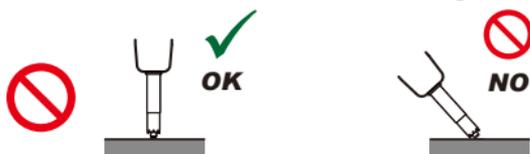
Évitez de soumettre la pointe de la sonde de température à un choc physique, et évitez de plier le cordon. Cela risque d'endommager la sonde ou de casser un fil.
