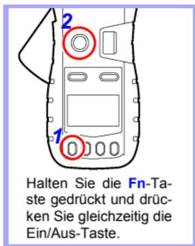
Halten Sie die **Fn**-Taste gedrückt und drücken Sie gleichzeitig die Ein/Aus-Taste.
