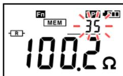
Zum Verlassen des Bildschirms „Read Memory“ drücken Sie die **Fn**-Taste oder die **OK**-Taste.
