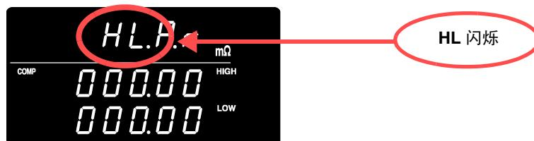
**oFF** ..... 蜂鸣器不鸣响。**In** ..... 蜂鸣器发出“滴滴”音（连续音）。**HL** ..... 蜂鸣器发出“滴滴滴…”音。**btH1** ..... IN 时，蜂鸣器发出“滴滴”音（连续音），Hi 和 Lo 时，蜂鸣器发出“滴滴滴…”音。**btH2** ..... 从 IN 以外变为 IN 时，蜂鸣器只发出一次“滴”（短音），Hi 和 Lo 时，蜂鸣器发出“滴滴滴…”的蜂鸣音。
