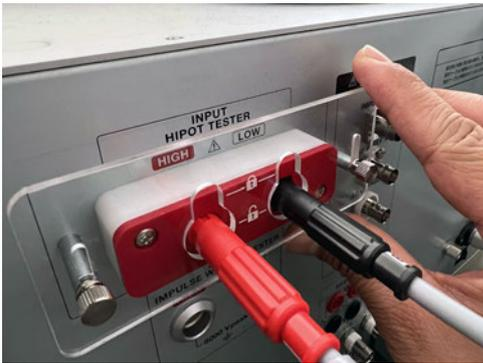
**6** 向下错开防电缆脱落板件，直至接触螺钉，然后锁定连接器。
