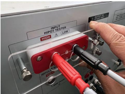
**7** 紧固防电缆脱落板件的螺钉。
