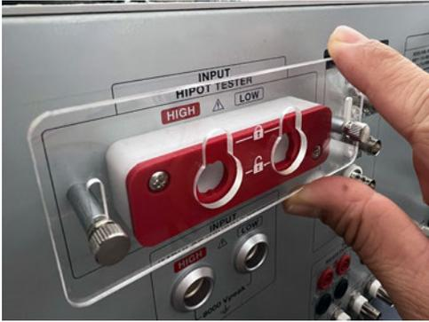
**5** 对准端子孔与连接线的连接器方向插到底。
