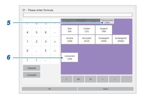
**5** Tap the [Trigonometric/CAN] tab.
