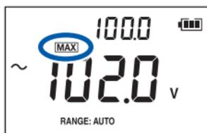
Raccordez les cordons de test au circuit à mesurer et appuyez sur **MAX/MIN**.
