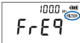
À chaque appui sur
