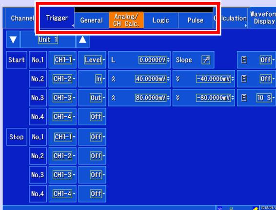
Configurez ces éléments lorsque vous souhaitez démarrer et arrêter l'enregistrement en fonction d'un signal spécifique.
