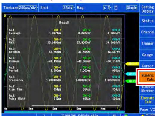
Le calcul est effectué automatiquement dès le démarrage de la mesure. Pour effectuer un calcul à l'aide de données existantes, sélectionnez **[Execute]**.
