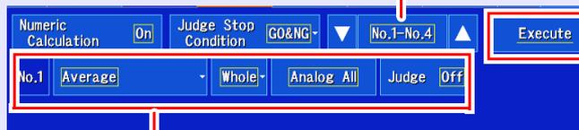
Vous pouvez régler le type de calcul, la gamme de calcul, le canal cible de calcul et la présence ou non d'un résultat de test.
