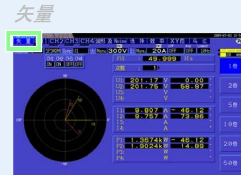
用数值与矢量显示 1 ~ 4 通道的电压、电流与功率测量值
