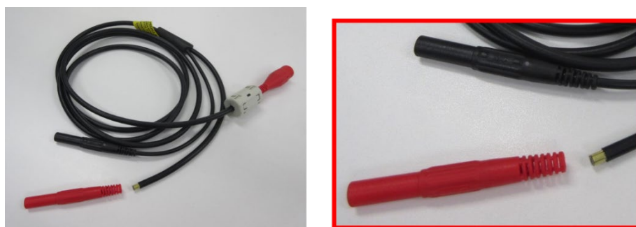
図 1 ケーブル破断
