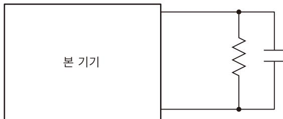
시험 데이터는 각 전압 200 MΩ 레인지에서 용량성 부하를 연결하여 100회 측정했을 때의 평균치에 대한 편차를 계산하고 있습니다. 또한, 콘덴서가 충전된 상태에서 측정치를 취득하고 있습니다.
