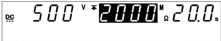
测试上限值已设为 2000 M Ω，不需要测试上限值，因此设为 **OFF**。按下 **ON/OFF** 键之后，设为 **OFF**。
