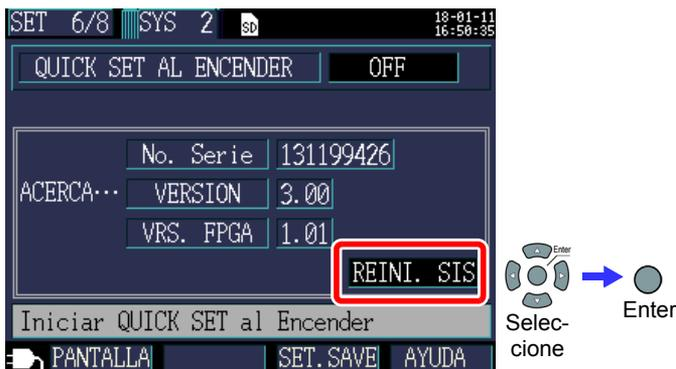
El llevar a cabo un restablecimiento del sistema hace que todos los ajustes que no sean el establecimiento de la frecuencia, el reloj, ajuste del idioma, dirección IP, sub máscara de red y el puerto de salida por omisión se regresen a sus valores por omisión. No se borrará la memoria interna del instrumento.
