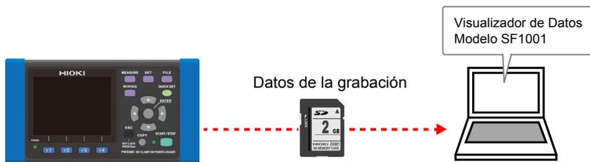
Para acceder a los datos, cárguelos desde la tarjeta de memoria SD en la que los grabó con una computadora con lector de tarjeta de memoria SD o utilice un cable USB para copiar los datos de la tarjeta de memoria SD o la memoria interna a la computadora.
