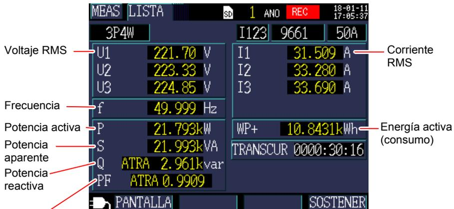
Selecciona entre factor de potencia PF (cálculo RMS) y desplazamiento de factor de potencia DPF (cálculo de la onda fundamental) y ajustes.
