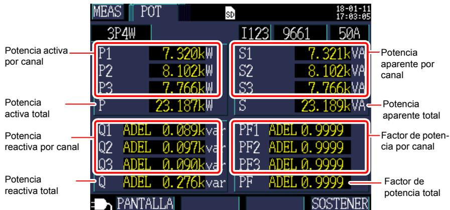
Cuando se usa el método de 3 fases/tres hilos/dos wattmetros (3P3W2M), la potencia activa, potencia reactiva, potencia aparente y factor de potencia para cada canal se obtienen por medio de un proceso de cálculo de dos wattmetros y no tiene significado físico. De cualquier manera, los valores para los canales individuales pueden servir como datos de referencia cuando se revisa la conexión.
