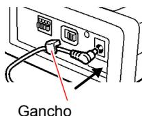
**4** Conecte la clavija de entrada del cable de energía a una toma de corriente.
