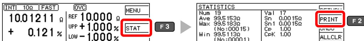
没有有效数据时，只打印数据数。有效数据数为 1 时，不打印样品的标准偏差和工序能力指数。
