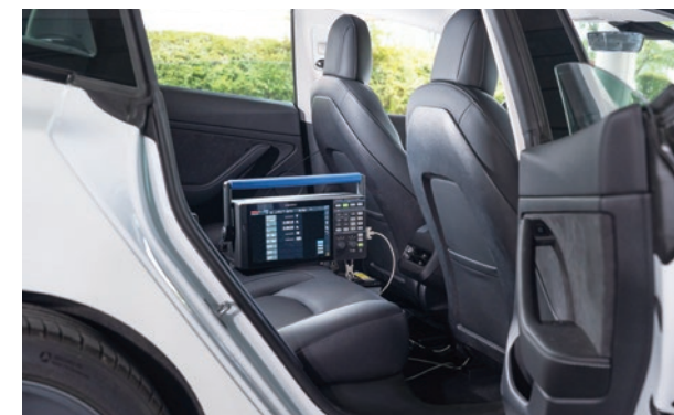
完成車の走行試験で電力の変換効率を解析
