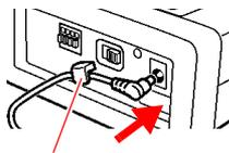
**4** 将电源线的输入插头连接到插座上。
