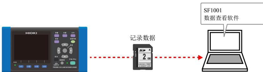
要访问数据，请使用带有 SD 存储卡读卡器的计算机载入 SD 存储卡上保存的数据，或使用 USB 电缆将数据从 SD 存储卡或内存复制到计算机。
