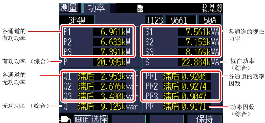
三相 3 线 2 瓦表法 (3P3W2M) 时，各通道的有功功率、无功功率、视在功率、功率因数为 2 功率表法的运算过程值，没有物理含义。但各通道的值为接线确认时的参考数据。要确认三相 3 线各通道的功率平衡时，请使用三相 3 线 3 瓦表法 (3P3W3M)。
