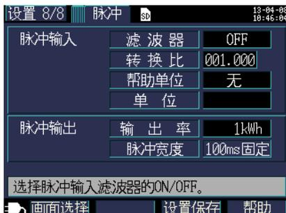
滤波器 ON（机械式接点用）：频率 25 Hz 以下
