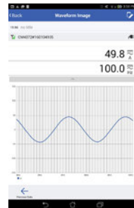
波形显示 简易示波器 为 PEAK OUT、Hz 功能 时, 不能进行波形显示。
