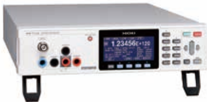
Fig. 7. Super Megohm Meter SM7110
