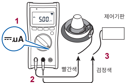
예: 버너 프레임 전류 측정( \mu\text{A} )
