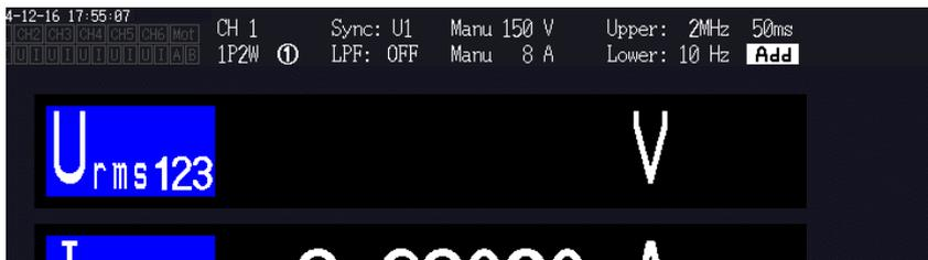
측정 레인지에 대해 0.5% 이하의 입력을 측정하면 측정치가 제로인 상태로 변화하지 않는 경우가 있습니다. 낮은 레벨까지 표시하고자 할 때는 제로 서프레스의 설정을 0.1%나 **OFF**로 변경해 주십시오.
