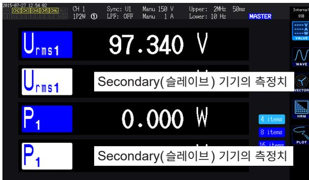
커스텀 화면의 표시 항목으로서 Secondary(슬레이브) 기기의 측정치를 선택한 경우는 항목명의 색이 반전합니다.
