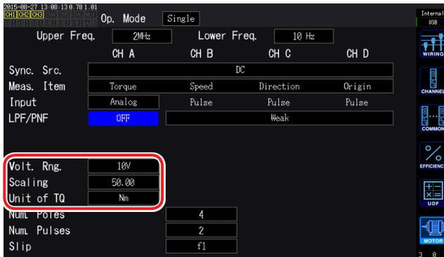
토크 입력을 Analog 로 설정한 경우는 센서에 맞춰 Volt. Rng., Scaling, Unit of TQ 의 3개 항목을 설정합니다.
