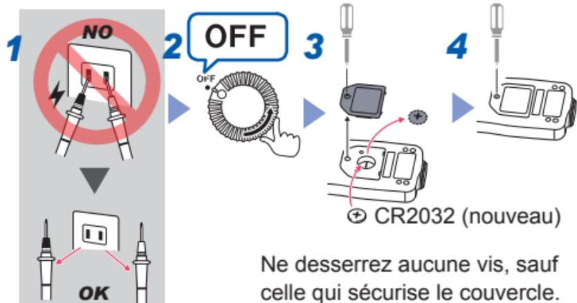
Ne serrez aucune des trois vis à l'intérieur du boîtier de pile. Dans le cas contraire, l'appareil pourrait rapporter des valeurs mesurées anormales.
