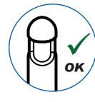
安装时,请勿使保护盖遮住钩夹 的开口部分。
