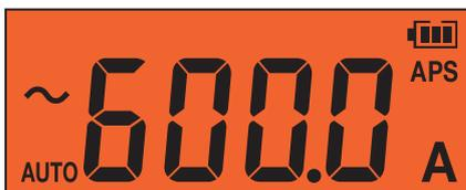
Le rétro-éclairage d'avertissement ne fonctionne que pour la valeur mesurée actuelle. Le rétro-éclairage d'avertissement ne fonctionne pas pour la valeur figée et les valeurs enregistrées des fonctions affichées MAX, MIN, AVG, PEAK MAX et PEAK MIN.
