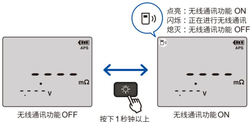
即使无线通讯功能处于 ON 状态，如果用 USB 连接线连接本仪器与 PC，无线通讯功能则会置为 OFF。
