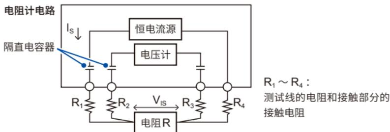
通过本仪器的SOURCE端子向被测对象输入交流电流 $I_s$ 。在SENSE端子上测量因被测对象的阻抗产生的电压下降 $V_{IS}$ 。此时，SENSE端子被连接在内部高阻抗电压计上。因此，表示导线电阻和接触电阻的电阻 $R_2$ 与 $R_3$ 上几乎没有电流流过。这样的话，电阻 $R_2$ 、 $R_3$ 基本没有电压下降。从而消除了电阻 $R_2$ 与 $R_3$ 的电压下降。根据同步检波，本仪器将被测对象的阻抗划分为有效电阻和电抗，并且仅显示有效电阻。
