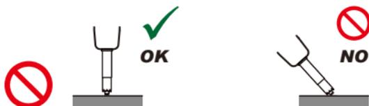
请勿使温度探头顶端承受过大的碰撞，也不要强行弯曲导线。否则可能会导致故障或断线。
