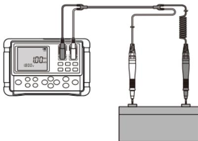
端子温度测量需要 9460 带温度传感器夹型测试线 (选件)。环境温度测量需要 9451/9451S 温度探头。
