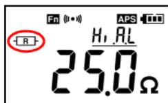
Écran des paramètres d'alarme pour mesure de résistance
