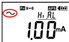
Écran des paramètres d'alarme pour mesure de courant
