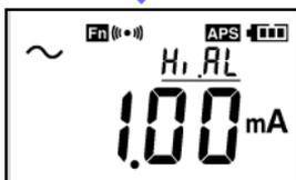
Paramètres d'alarme de courant
