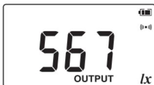
La tension est émise par la borne D/A OUTPUT en fonction de la valeur de mesure. (**OUTPUT** s'allume.)
