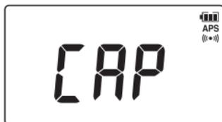
Si vous appuyez sur **0ADJ** alors que le capuchon de capteur fourni n'est pas fixé au capteur d'éclairage (lorsque le décompte est équivalent à 1 lx ou plus), **[CAP]** s'affiche sur LCD.
