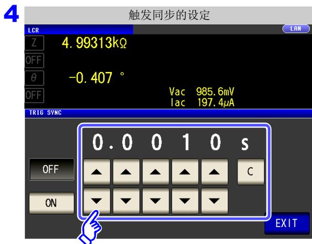
利用 ▲、▼ 设定通过施加触发而输出测量信号～测量开始的等待时间。
