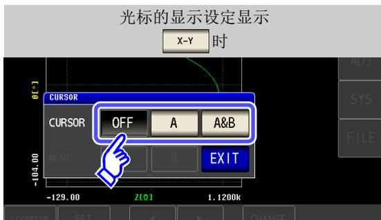
通过 GRAPH 与 X-Y 连锁光标的显示设定与光标的移动设定。
