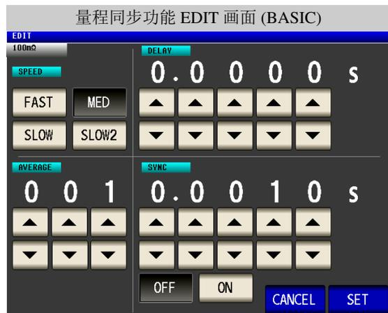
2. 分别进行速度、平均值、触发延迟、触发同步输出功能的设定。
