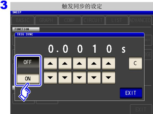
选择触发同步输出功能的 **ON/OFF**。
