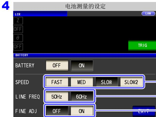
“电池测量的设定”的 SPEED、FINE ADJ 功能时的设定为电池电压测量、FINE ADJ 功能时的设定。请根据“4.2.7 设定测量速度”(⇒第 70 页)设定阻抗测量时的 SPEED。
