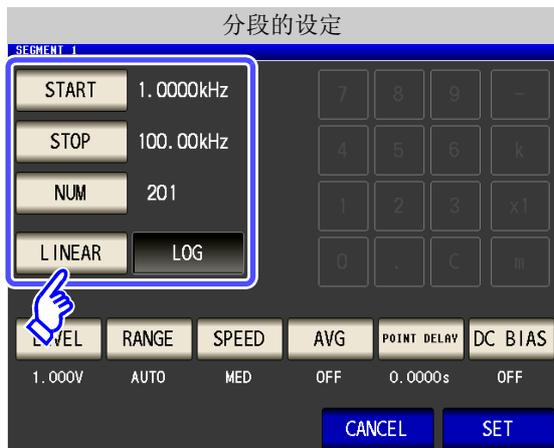
扫描点的设定方法利用 **START-STOP**（设定扫描的开始值与结束值）固定。
