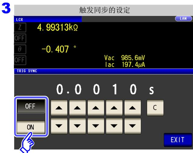
选择触发同步输出功能的 ON/OFF。
