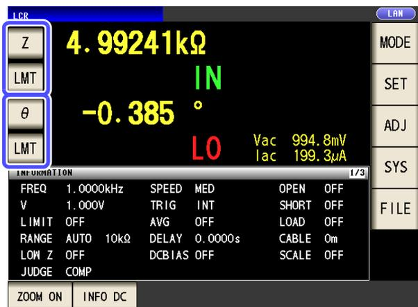
基于比较器测量、BIN 测量的判定对第 1 参数、第 3 参数起作用。
