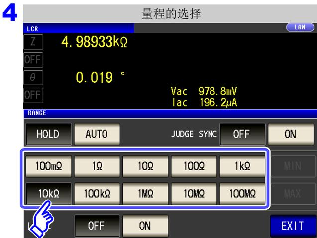
请根据测试物与测试电缆的阻抗总和设定量程。
