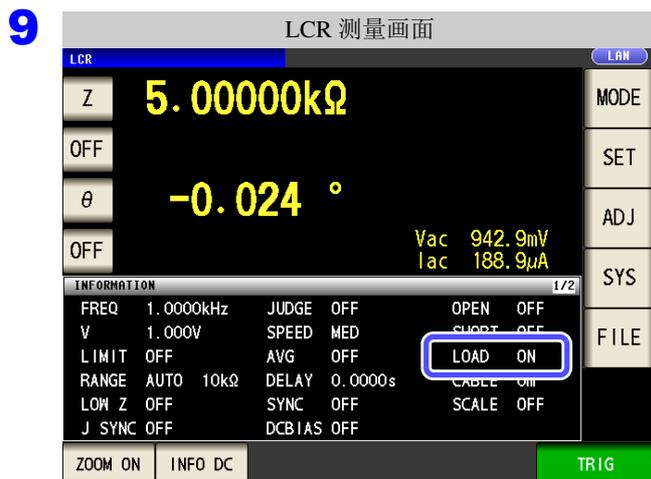
在设定的测量条件下，负载补偿有效时，测量画面测量条件显示的 LOAD 项目变为 ON 状态。
