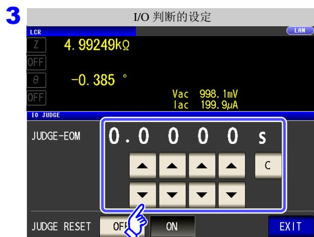
可利用 ▲、▼ 设定比较器、BIN 判定结果输出～ $\overline{\text{EOM}}(\text{LOW})$  输出之间的延迟时间。
