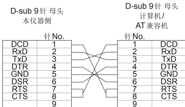
推荐电缆：HIOKI 制 9637 RS-232C 电缆 (1.8 m)
