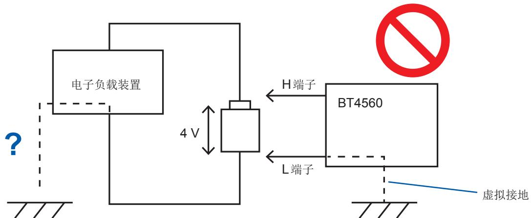
连接的仪器内部接地或接地间的容量较大时
