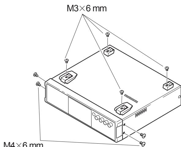
**1** 拆下本仪器底面的支撑脚和侧面盖子的螺钉
