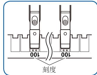
请进行夹住作业，以使 L2002 顶端的针可靠地进入调零板的 2 个孔(通孔)中。如果针未进入孔中，则会显示错误，不能进行适当的调零。
