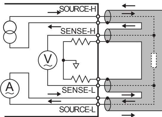
图. 4端子对构造
