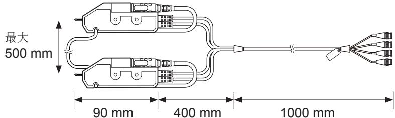
1. 配置时，将探头的SENSE侧朝向内侧(红黑双方)，使探头的针尖与实际被测对象的宽度相同。
