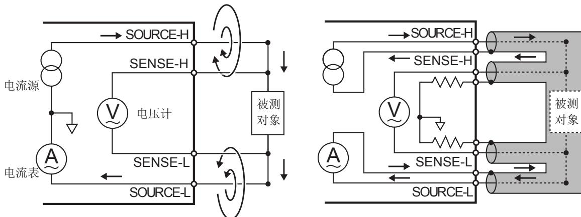
由于**4端子测试法**不受配线电阻与接触电阻的影响，因此适合于低电阻测量。但测量电流产生的磁场会以感应电动势的形式对SENSE端子产生影响。
