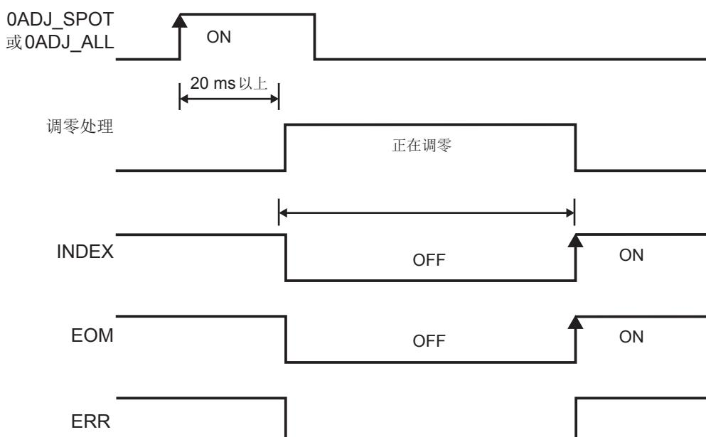
根据调零的结果进行ERR信号的ON/OFF。调零成功时，变为OFF状态；失败时，与EOM同步变为ON状态。
