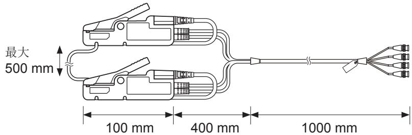
1. 配置时，将探头的SENSE侧朝向内侧(红黑双方)，使探头的SENSE之间与实际被测对象的宽度相同。
