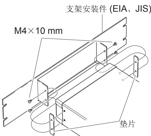
**2** 将垫片放入本仪器侧面两侧，然后用M4×10
