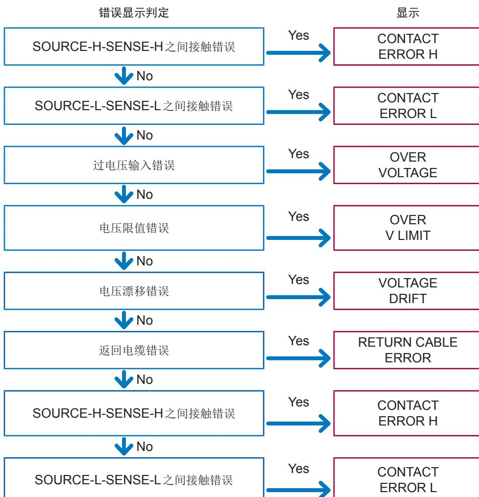
按上图所示的测量顺序对测试异常进行判定并显示错误。(在受理触发～执行电压测量之间以及阻抗测量期间，进行测量电流异常的监视)
