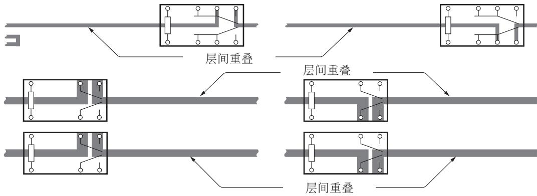
图. 切换装置的图案布局示例(2层以上的电路板时)
