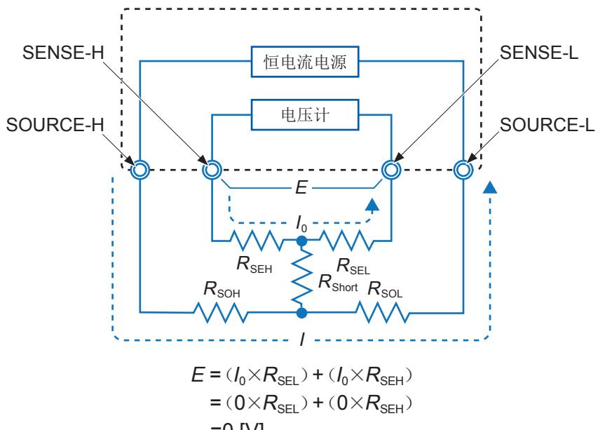
图. 相近地连接  $0\ \Omega$  的状态
