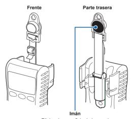
Fíjelo a la superficie de la pared (con la placa metálica adherida).
