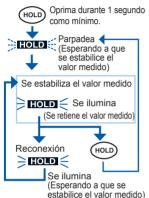
Oprima (HOLD) durante 1 segundo como mínimo. ([HOLD] parpadea: el instrumento está esperando a que se estabilice el valor medido.)
