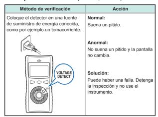
Para verificar correctamente la carga eléctrica, no use el instrumento con las puntas de medición colocadas alrededor. Esto deteriora la sensibilidad de detección de la carga eléctrica.
