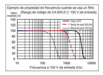
Ejemplo: La frecuencia de energía en una aeronave o embarcación es de 400 Hz Cuando el voltaje es 100 V
