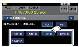
**Select the integration time.** (100 PLC, 10 PLC, 1 PLC, 0.2 PLC, 0.02 PLC)
