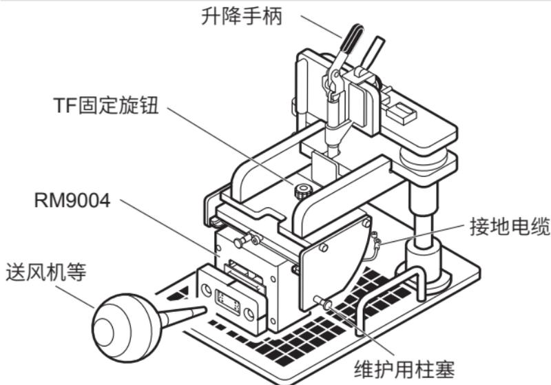
抬起RM9003测试用台架的升降手柄，拆下背面的RM9005连接线和接地电缆。（关于详细操作方法，请参照使用说明书）
