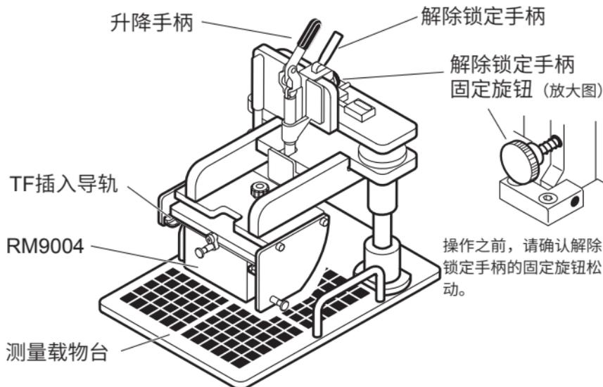
沿着RM9003测试用台架的TF插入导轨插入RM9004测试针单元。
