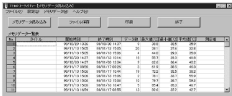
注記 パソコン側から、温度計のメモリデータをすべて消去することができます。[メモリデータ] - [メモリデータクリア]を選択します。
