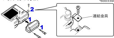
1 本体側ユニットと増設ユニットのゴネクタをあ 2わせて押し込み、増設ユニットに装着されてい るネジ2か所で固定する。
