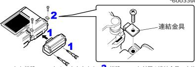
わせて押し込み、増設ユニットに装着されてい るネジ2か所で固定する。
