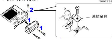
$m{1}$  本体側ユニットと増設ユニットの $ar{f j}$ ネクタをあ  $m{2}$ わせて押し込み、増設ユニットに装着されてい るネジ2か所で固定する。
