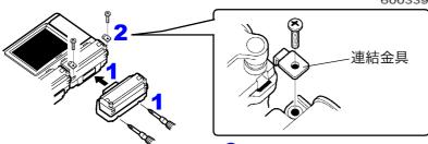
わせて押し込み、増設ユニットに装着されてい るネジ2か所で固定する。
