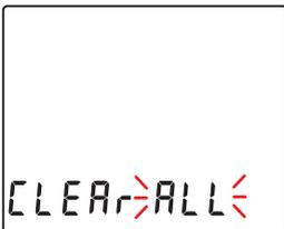
Alle Daten können außerdem durch Ausschalten des Instruments und darauffolgendes Einschalten und gleichzeitiges Gedrückthalten der [READ]-Taste gelöscht werden.
