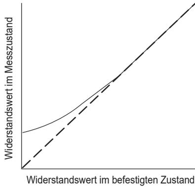
Abb. 16 Unterschied zwischen dem befestigten und dem Messzustand
