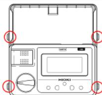
Ziehen Sie jeden der vier Doppel-Spaltringe etwas auseinander und führen Sie den Ring durch ein Befestigungsloch an dem Instrument.
