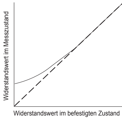
Abb. 16 Unterschied zwischen dem befestigten und dem Messzustand
