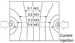
Figure 7. Equipotential line of the metal plate
