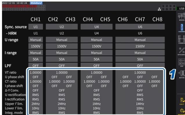
**1** Para abrir la ventana de ajustes, toque el área de visualización detallada del canal.
