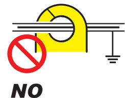
No sujete el sensor en un cable apantallado.
