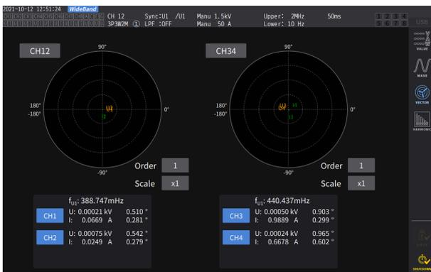
La visualización del diagrama de dos vectores muestra dos gráficos de cada configuración de cableado seleccionada.
