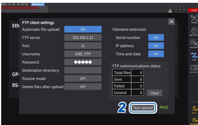
Si no se puede enviar el archivo de prueba, compruebe la configuración de carga automática de archivos del instrumento y la configuración FTP de la computadora.
