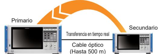
El instrumento primario muestra todos los datos.
