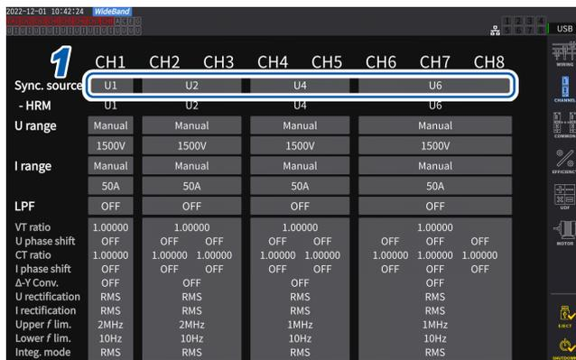
**1** Toque el cuadro **[Sync. source]** de la configuración de cableado que desee establecer para abrir la ventana de ajustes.
