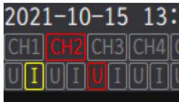
Ejemplo: Ch. 1 está sobrecargado (amarillo), Ch. 2 está en una condición de sincronización y desbloqueo (rojo), y la entrada de voltaje de Ch. 3 está en una condición de pico fuera de rango (rojo).
