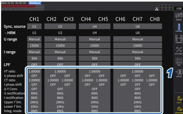
**1** Para abrir la ventana de ajustes, toque el área de visualización detallada del canal.
