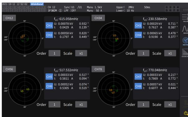
La visualización del diagrama de cuatro vectores muestra cuatro gráficos de cada configuración de cableado seleccionada.
