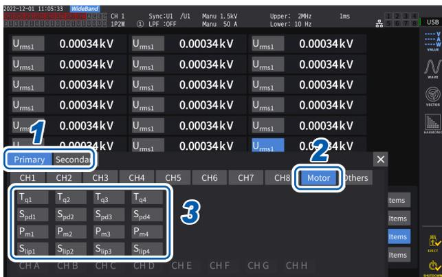
1 Para el modo de enlace óptico, elija entre [Primary] (configure el instrumento como primario) y [Secondary] (configure el instrumento como secundario).
