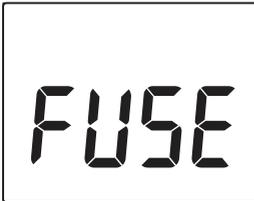
Chaque borne SOURCE de l'appareil est équipée d'un fusible pour la protéger contre l'entrée de surtension. Si une surtension est appliquée par accident et qu'un fusible a fondu, remplacez-le. (p. 135)
