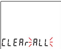
Il est également possible d'effacer toutes les données en mettant hors tension, puis sous tension en maintenant enfoncée la touche **[READ]**.
