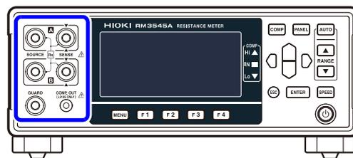
将红色插头连接到 SOURCE A 端子与 SENSE A 端子上，将黑色插头连接到 SOURCE B 端子与 SENSE B 端子上，将 GUARD 插头连接到 GUARD 端子上。
