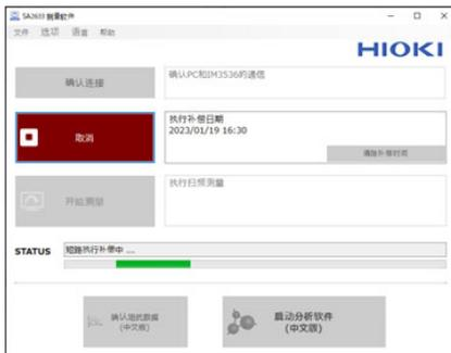
可通过 SA2633 测量软件的 [STATUS] 确认正在执行的状态。
