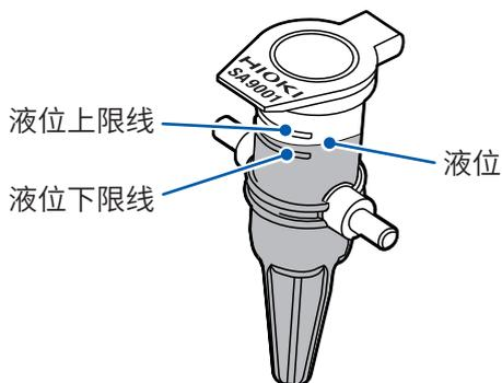
请注意倾斜度，确保 SA9001 电极容器中的液位处在液位上限线与液位下限线之间。
