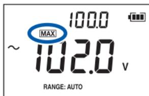
Messleitungen mit dem Messobjekt verbinden und **MAX/MIN** drücken.
