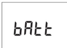
Quando la carica della batteria è dello 0% (meno di  $3,0\text{ V} \pm 0,1\text{ V}$ ), **[bAtt]** sul display lampeggia per 3 secondi e l'alimentazione viene interrotta.
