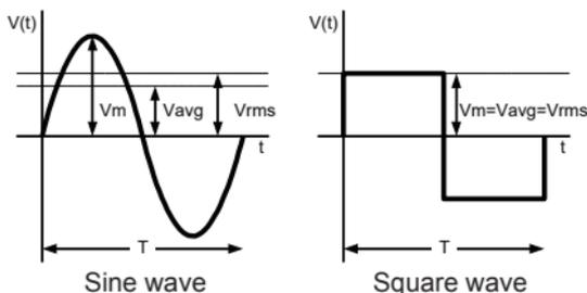
$V_m$ : Maximum value,  $V_{avg}$ : Average value,  $V_{rms}$ : RMS,  $T$ : Time period
