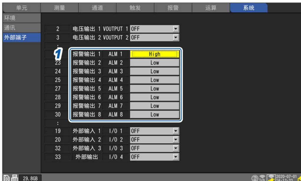
1 在 [报警输出 1] ~ [报警输出 8] 中选择输出报警时的电压电平
