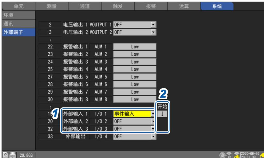
**1** 在[外部输入 1] ~ [外部输入 3]中选择[事件输入]
