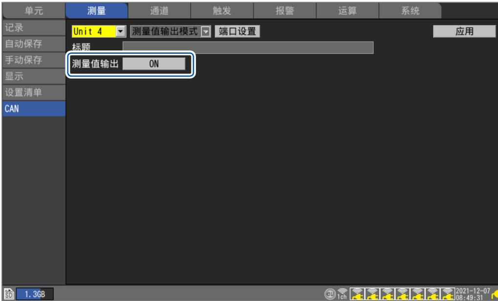
利用 CAN 单元设置软件进行测量值输出的各种设置。可在 LR8450 中选择是否作为全体输出测量值。
