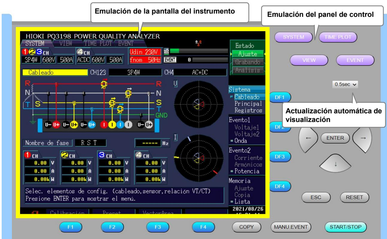
Haga clic en las teclas del panel de control para realizar las mismas operaciones que las teclas del instrumento.
