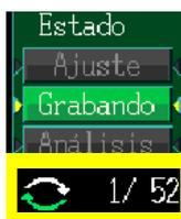
Durante el registro repetido, se muestra la iteración actual y la cantidad total de iteraciones definidas, y la flecha verde parpadea.
