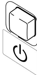
Appuyez sur le commutateur de mise sous tension à l'avant de l'appareil et maintenez-le enfoncé pendant environ 1 seconde lorsqu'il est en état de fonctionnement.
