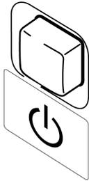
Appuyez sur le commutateur de mise sous tension à l'avant de l'appareil lorsqu'il est en état de veille.
